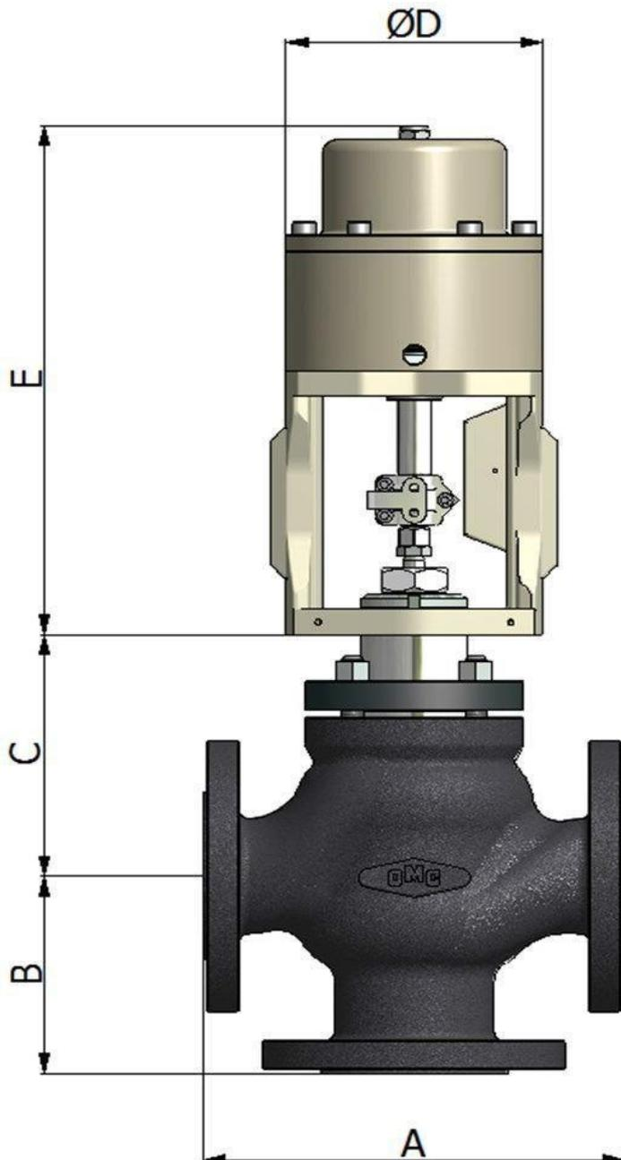
\* In accordo alla norma EN1092-1 le flange DN65 PN16 in acciaio devono essere fornite con 8 fori. Possono essere fornite con 4 fori solo su specifica richiesta del committente.
